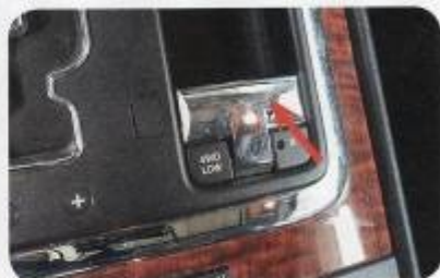
Дернешь за T-образный рычажок, и одновременно с «понижайкой» заблокируются все три дифференциала!
