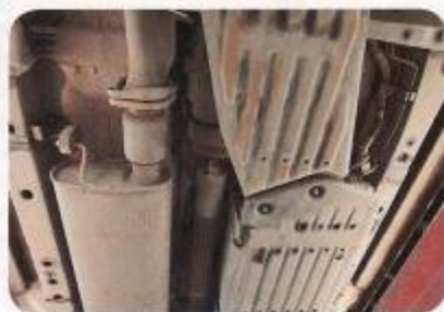
Элементы выпускной, топливной систем и трансмиссии лежат глубже прочных лонжеронов рамы Jeep
