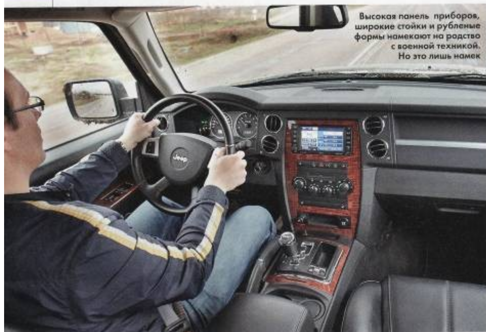
Белая подсветка приборного щитка и мелкая оцифровка не способствуют быстрому считыванию информации
