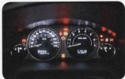
Белая подсветка приборного щитка и мелкая оцифровка не способствуют быстрому считыванию информации
