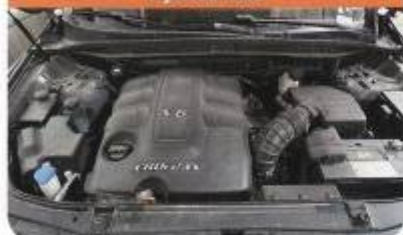
Пластмассовая накладка-обманка скрывает поперечное расположение двигателя
