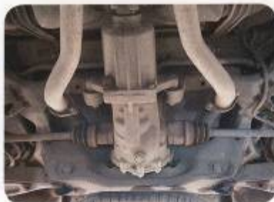
Низковисящие трубы выпускной системы Hyundai намекают на то, что владельцы должны быть поосторожнее на грунтовке
