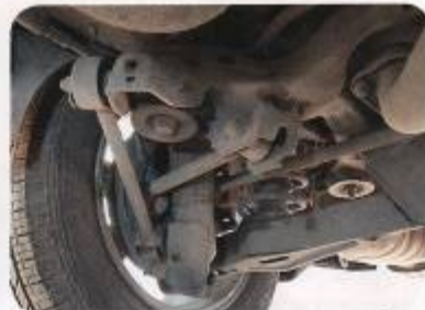
Тонкое хитросплетение рычажков задней подвески позволяет ix55 хорошо стоять на асфальте. Но они в зоне риска на офф-роуде
