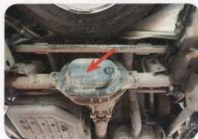
Картер заднего редуктора заведомо снижает геометрическую проходимость американского джипа. Но его не «снесешь»!
